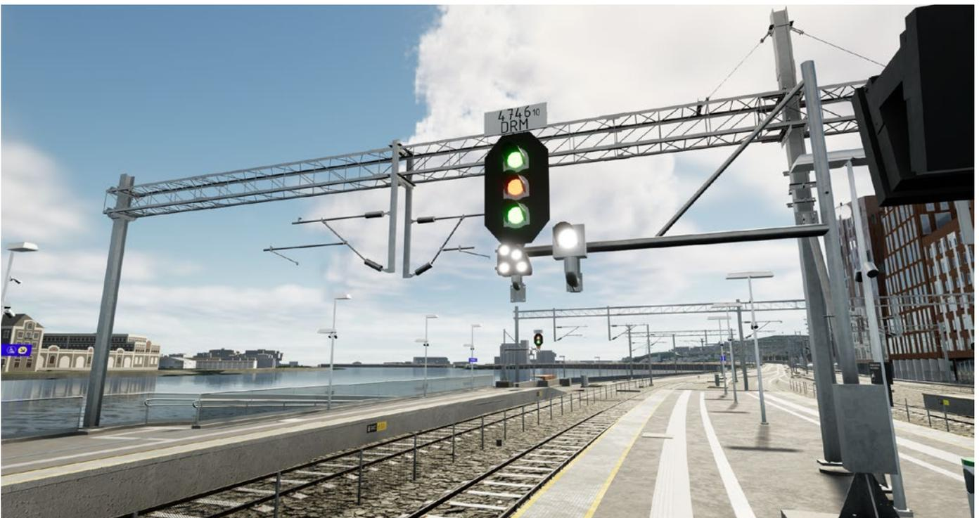
**Bild 1: 3D-Export von Signalen, nachbearbeitet mit der Unreal-Spiele-Engine und im Kontext zur Überprüfung von Sichtungsproblemen dargestellt**
